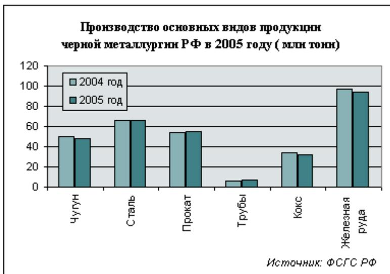
За прошедший год наблюдались позитивные изменения в технологической составляющей черной металлургии: доля электростали выросла с **20,41%** до **21,33%**, кислородно-конверторная осталась на уровне **2005 г.** – около **59%**, а доля мартеновской стали снизилась с **20,39%** до **19,77%**. Производство стальной заготовки на МНЛЗ выросло до **68,36%** от общей выплавки стали.
